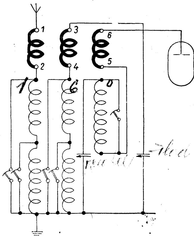
Cívky PALAFER KOLIBRI navinuté hodí se jak pro jednoduchá zapojení audionová, tak i co vstupní a oscilátorové cívky superhetů. Jsou upraveny pro ladící kondensátor  $450\text{ pF}$ .
