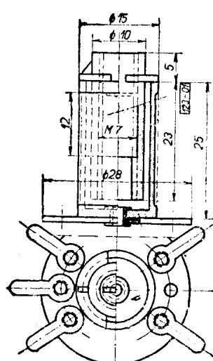
Vývoj konstrukce krátkovlnných cívek směřuje k dosažení nejmenších ztrát při malých rozměrech cívky. Provedení PALAFER KOLIBRI plně odpovídá těmto požadavkům a umožnuje stavbu kvalitních krátkovlnných rozsahů. Šťastně volená konstrukce mimoto dovojuje podle potřeby využiti výhod vf. železového jádra velmi jednoduchým způsobem: prostým umístěním vložky se šroubovým vf. jádrem obj. č. 6112 do cívky. Vložka se na kostru přilepí benzolem, kterým se spojné plochy natrou, smačknou a nechají zaschnout.
