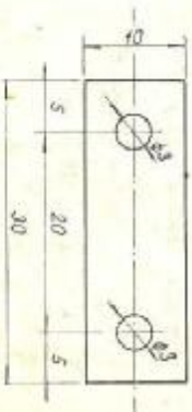
Obr. 15b - Umrštění spojovací podložky na úhelníčkách a spo- jovací podložka.
