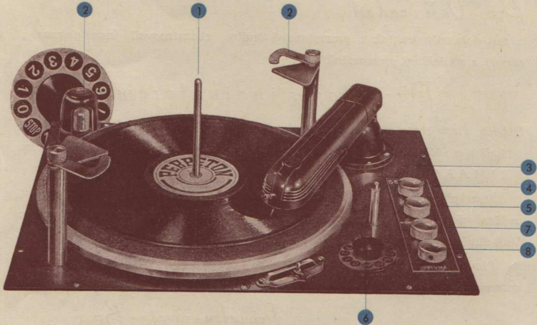
DESET GRAMOFONOVÝCH DESEK nasadíme na střední tyčinku 1 a položíme na nosníky 2. Do přenosky vložíme trvalou jehlu, která spolehlivě přehraje 10 desek. Pak položíme přenosku zpět na podstavec 3.
