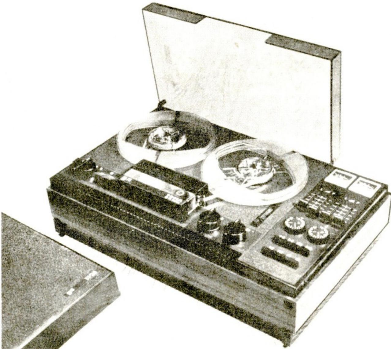
Magnetofon B 73 je uznáván odborníky především pro tříhlavý systém — páskový monitor. Jedině rozdělení základních funkcí magnetofonu na samostatné hlavy (mazací, nahrávací, snímací), umožňuje kontrolovat hotový záznam už při jeho pořizování. Tomuto systému kontroly se říká „odposlech“ a nelze ho dosáhnout na magnetofonech s kombinovanými hlavami.
