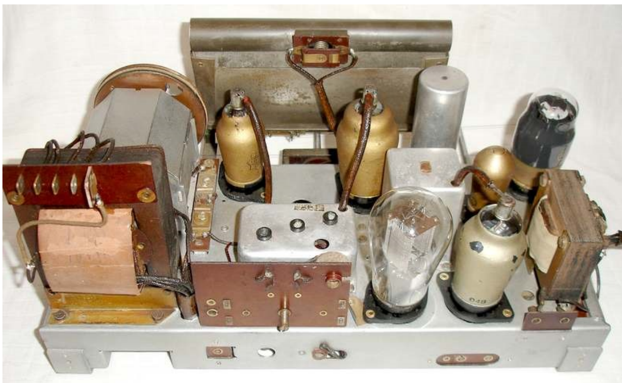
Príklad skompletovaného šasí pri pohľade zozadu. Ešte chýbajú malé nálepky označujúce použité elektrónky.
