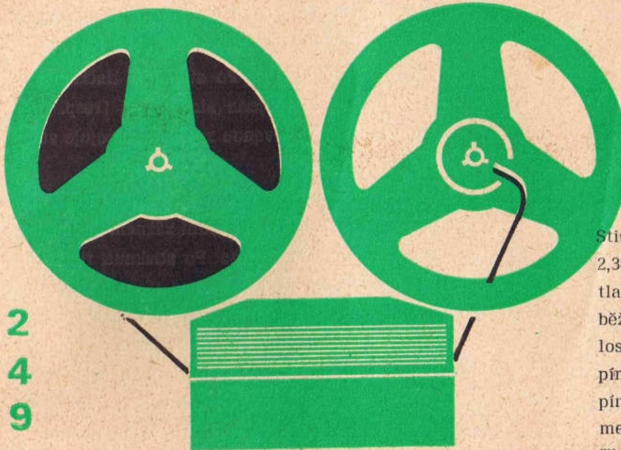
Na levý hřídel nasaďte plnou cívku (2) a prázdnou na pravý (12). Odvíňte zelený zaváděcí pásek, mírně jej napněte a vložte do zakládací štěrbiny. Počátek pásku zasuňte do výřezu prázdné cívky a několikerým otočením zajistěte. Dbejte, aby pásek nebyl překroucen a před každým spuštěním magnetofonu byl napnut. Rychlosť posuvu pásku přepínejte tlačítka (3) jen je-li magnetofon vypnut síťovým vypínačem (20). Jinak nelze žádné tlačítko stisknout!
